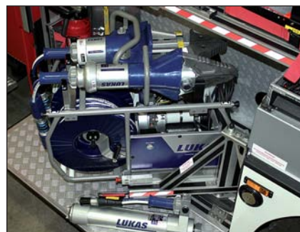
Schere-Spreizer: Der neue Rettungssatz wurde auf dem Fahrzeug verlastet.
